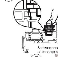
3. Установить штифт ручки с нейлоновой втулкой в редуктор 3630 **ВАЖНО: высота штифта относительно плоскости профиля после установки - не менее 27 мм!!!**
