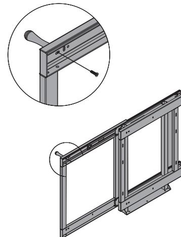
Выдвиньте раму и установите ручку на раму с помощью винтов M4
