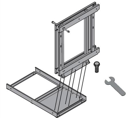
Зафиксируйте раму на основании с помощью шестигранных винтов M5 и гаечного ключа
