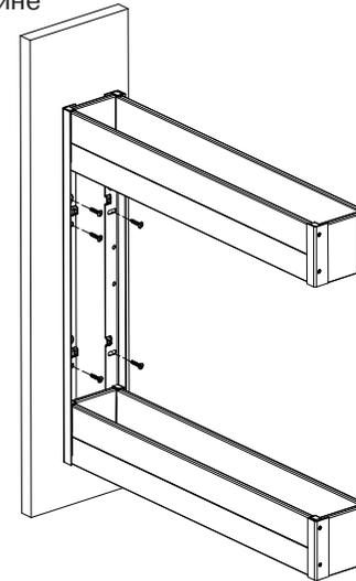
Выдвиньте направляющие и зафиксируйте корзину на направляющих с помощью винтов M4
