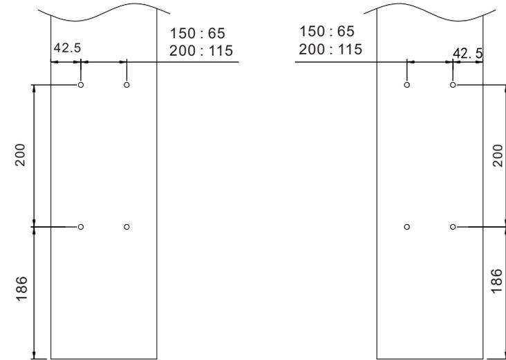
Схема присадки фасада при установке направляющих с левой стороны
