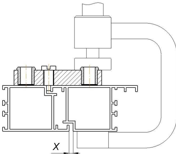
3. Просверлить в соответствующих втулках кондуктора отверстия  $\text{Ø}11\text{ мм}$ .
