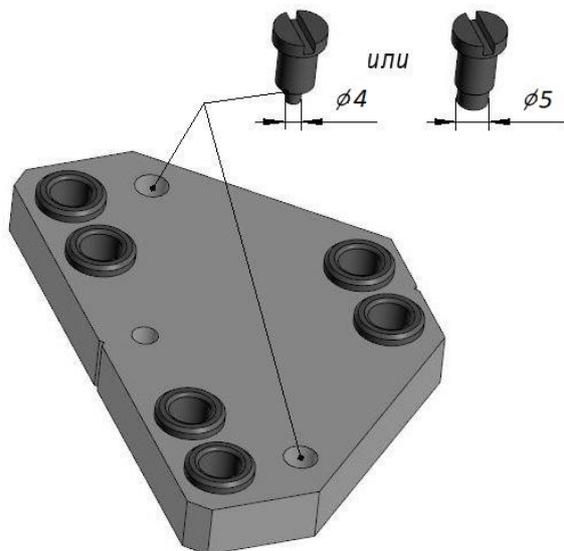
2. Установить кондуктор по разметке на профилях и закрепить его струбциной. Профиля должны касаться выбранных винтов и обеих сторон.
